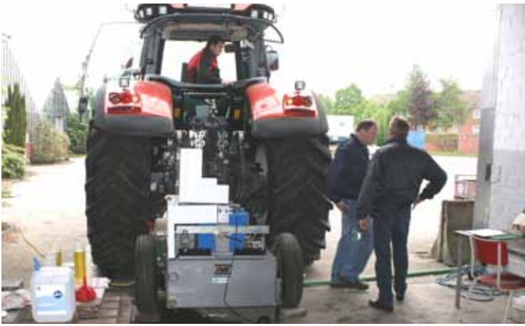
Bij de kandidaten zijn het maximum aftakasvermogen en het afgegeven vermogen bij 650 toeren aan de 1000-toerenaftakas gemeten om de motorkarakteristiek te bepalen.
